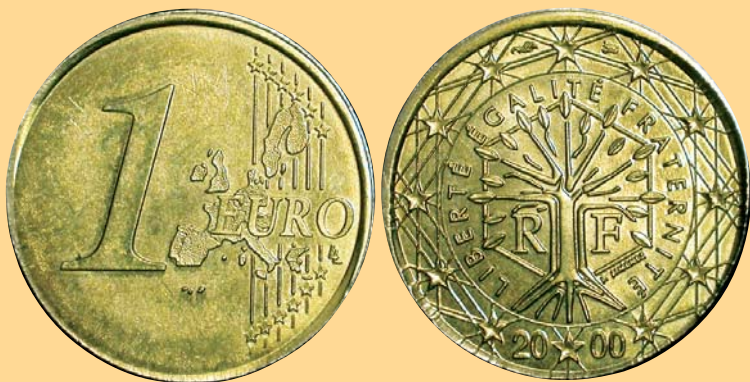
Pièce fautive : cette pièce de 1 euro a été frappée sur flan de 20 centimes ; elle pèse 5,79 grammes, mais a le diamètre d'une pièce de 1 euro à cause de son écrasement par la presse.
